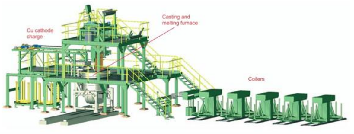
Grafički prikaz A-3: Shema UPCAST postrojenja za izvlačenje bakrene žice
